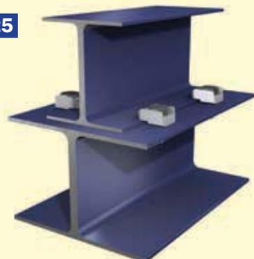
Befestigung eines I- an einem H-Träger mittels Durchbohrung des H-Trägers
