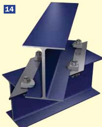
Versetzte Trägerverbindung (Winkel  $\neq$  90 Grad)
