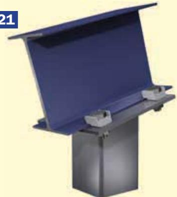
Geneigte Verbindung eines Trägers an einem Hohlprofil
