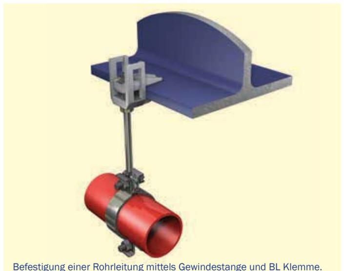
Befestigung einer Rohrleitung mittels Gewindestange und BL Klemme.
