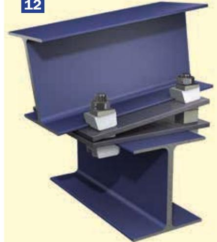
Um 90 Grad versetzte, mittels Distanzstücken geneigte Trägerverbindung
