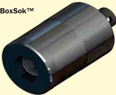
Der **BOXSOK** Schraubenaufsatz ist ein spezielles Montagewerkzeug für **BOXBOLT** Hohlprofilbefestigungen. Er fixiert den Bund der Sprezhülse und zieht gleichzeitig mit der Sechskantschraube den Konus an, bis die Hülse gespreizt ist. **BOXSOK** ermöglicht die Montage von **BOXBOLT** mit nur einem einzigen Werkzeug. Die Montagezeit wird dadurch erheblich verkürzt, und das Verletzungsrisiko gemindert.
