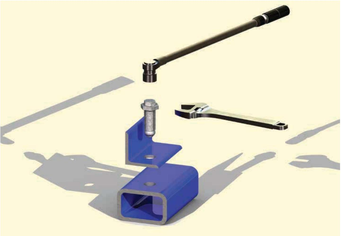
**SCHRITT 1:** Bohren Sie in die zu verbindenden Profile die Löcher mit dem erforderlichen Durchmesser und Abstand. Entgraten Sie die Bohrlöcher, und positionieren Sie die Profile übereinander, so dass:
