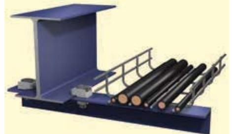
Winkelprofil als Träger für Kabelkanal an Stahlträger
