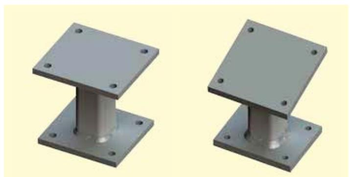
An den Stützen ist – oben und unten – jeweils eine Montageplatte angeschweißt. Für den Einsatz in geneigten Konstruktionen können die Montageplatten in verschiedenen Winkeln angeschweißt werden. Je nach Bedarf lassen sich auch andere Variationen anfertigen.
