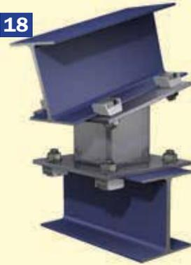
Um 90 Grad versetzte Trägerverbindung mit geneigtem Montagegestützen
