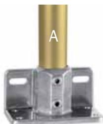
Der Typ L69 erfüllt die gestellten Anforderungen der DIN EN ISO 14122-3. Eine Fußleiste kann ohne große Montagevorbereitungen befestigt werden. Die ovale Bohrung gewährleistet eine größere Flexibilität bei der Befestigung. Eine passende Fußleiste ist von **KEE SAFETY** erhältlich (siehe S. 36).  $\emptyset$  gibt den Durchmesser der Befestigungsbohrung an.
