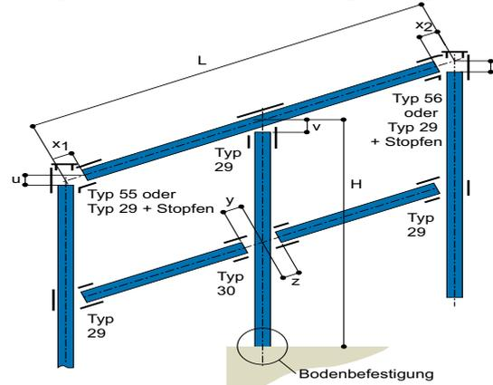
Tabelle 6 enthält Angaben über die zum Berechnen der Länge des Handlaufs und des Knielaufs bei einem Winkel zwischen 30° und 45° erforderlichen Abmessungen.
