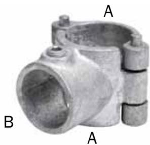
Dieser Verbinder ist dafür ausgelegt, um Ansätze und Erweiterungen an bestehenden Geländern anzubringen, ohne diese demontieren zu müssen. Dieser Verbinder kann an einem vorhandenen Rohr der Größe 7 (42,4mm Außendurchmesser) befestigt werden.
