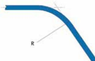
Tabelle 21 informiert über Details zu Standardradien 'R' der Rohrbiegung durch die Kee Safety Ltd. Sollten diese Standardradien nicht passen, kann Rohr der Größen 5 bis 9 ab einem Minimum von 500mm in jedem beliebigen Radius gebogen werden.
