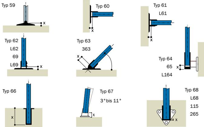
Tabelle 13 enthält Angaben über die Abmessung 'x' der Bodenbefestigung, die von der Höhe 'H' abzuziehen ist, um die Länge des Pfostens 'h' zu erhalten.
