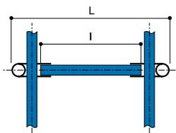
Tabelle 9 enthält die Abmessung 'x', die von der Gesamtbreite des Regals 'L' abgezogen ist, um die Länge der Querstange in der Formel  $I = L - x$  zu ergeben.
