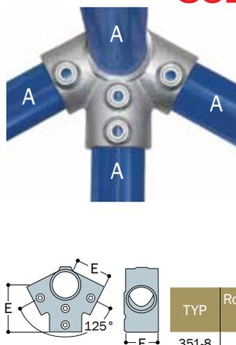
Typ 351 ist für kleinere gebäudeähnliche Konstruktionen, wie z. B. Gewächshäuser, geeignet und gewährleistet ausgezeichnete Belastungswerte. Bei der Verwendung in Verbindung mit Typ 350 kann eine zusätzliche senkrechte Stützverbindung eingebaut werden. Zwei Stellschrauben am Sockel der senkrechten Stützverbindung sorgen für einen hohen Auszugswiderstand und somit für eine stabile Konstruktion.
