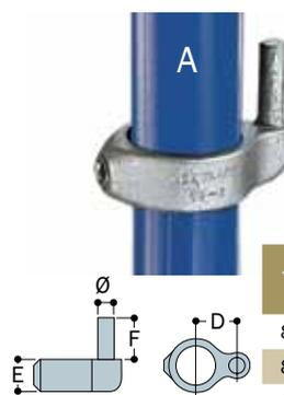
**Hinweis:** Werden die Typen 78 und 83 als Türscharnier eingesetzt, ist darauf zu achten, dass die Scharnierstifte des Typ 83 in entgegengesetzte Richtung zeigen, um den Eigenhalt der Tür zu gewährleisten.
