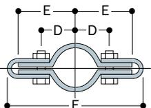
Zur Kostensenkung können Schellen des Typs 82 für die Befestigung von Füllelementen aus Sperrholz, Trespa etc. mit Stärken von bis zu 10 mm ohne Sicherheitszubehör verwendet werden. Im Lieferumfang sind Sechskantschrauben (M6 x 35 mm) und Muttern enthalten. Ø gibt den Durchmesser der Befestigungsbohrungen an.
