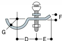
Zum Lieferumfang gehören eine Sechskantschraube M6 x 50 mm mit Mutter sowie ein Dichtring. Ø gibt den Durchmesser der Bohrung an.
