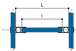
Tabelle 11 enthält Abmessung 'x', die von der Gesamtbreite der Querrohre abgezogen ist, um die Länge der Querstangen in der Formel  $I = L - x$  zu erhalten.
