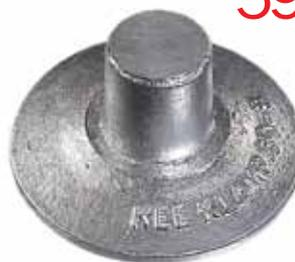
Standfuß, der genau in den Rohrdurchmesser passt und ohne Stellschraube befestigt wird. Typ 59 eignet sich nur für Rohre mit Wandstärken von min. 3,2 mm sowie zur Verwendung in leichten, selbsttragenden Konstruktionen.
