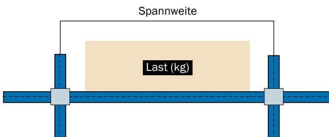
Tabelle 23 gibt eine Übersicht über die zulässige Beanspruchung in Kilogramm, die unter Beachtung der vorgenannten Einschränkungen von einzelnen Rohren nach DIN EN 10255 (ISO 65) getragen werden dürfen, wenn sie als Pfosten verwendet werden.
