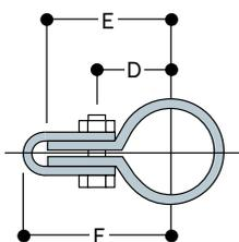
Zur Kostensenkung können Schellen des Typs 81 für die Befestigung von Füllelementen aus Sperrholz, Trespa etc. mit Stärken von bis zu 10 mm ohne Sicherheitszubehör verwendet werden. Im Lieferumfang sind Sechskantschrauben (M6 x 35 mm) und Muttern enthalten. Ø gibt den Durchmesser der Befestigungsbohrungen an.
