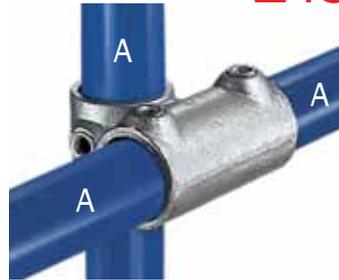
Typ 145 ergibt eine um 90° versetzte Kreuzverbindung. Ein Durchgang ist mit 2 Stellschrauben ausgestattet, so dass Stoßverbindungen möglich sind. Sofern keine Rohrverbindung in Längsrichtung erforderlich ist, kann Typ 45 als kostensparende Alternative eingesetzt werden. Zur Ermittlung der Rohrlänge für den Pfosten, muss Abmessung "G" addiert werden.
