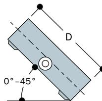
Hinweis für die paarweise Verwendung (z. B. bei Treppen oder Rampen): Rohrverbinder des Typs 27 liegen nur in einseitiger Ausführung vor. Das heißt, die Stellschrauben auf einer Seite der Treppe oder Rampe zeigen nach innen. Als Alternative siehe Typ 29 (siehe Seite 38).
