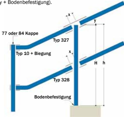
Tabelle 4 enthält Angaben, die zum Berechnen der Rohrlänge bei einem Winkel zwischen 11° und 30° erforderlich sind.
