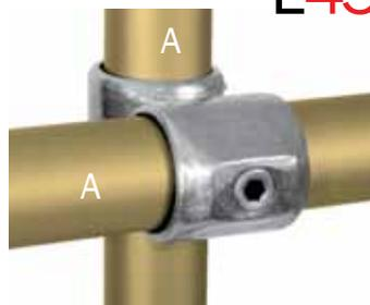
Diese Variante ergibt eine um 90° versetzte Querverbindung. Sie wird häufig an Sicherheitsgeländern verwendet. Dabei lassen sich hier durch Verwendung eines durchgehenden waagerechten Geländers sowohl Rohrverschnitt als auch Schneidarbeiten auf ein Minimum reduzieren.
