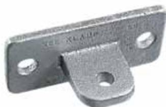
Typ M58 kann für verschiedene Befestigungsarten an Wänden und für Verstrebungen in Betracht gezogen werden. In Verbindung mit Typ F50 bildet den Gelenkverbinder Typ C58. Der Durchmesser der Laschenbohrungen beträgt 10 mm.
