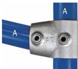
Typ 86 dient der Verbindung eines Knielaufs mit dem Endpfosten eines Geländers. Er erlaubt die Einstellung von Neigungswinkeln von 0° bis 11°. Dieser Verbinder darf nicht eingesetzt werden, wenn das Rohr im Durchgang gestoßen werden muss.
